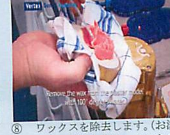
⑧ ワックスを除去します。(お湯を使い模型からワックスを完全に除去してください)
