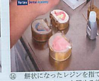
⑭ 餅状になったレジンで指で圧接し、フラスコを閉める前にシートを被せます。
