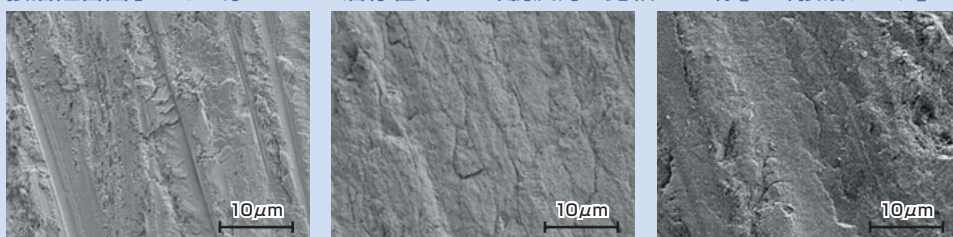
切削直後 (×2000) 切削時に生成される厚いスミア層に覆われている。
